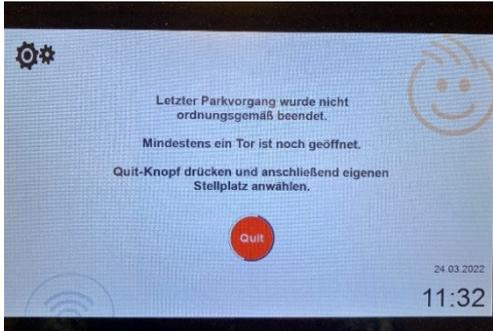
Wenn das Tor der Parkpalette zu lange offensteht, erscheint eine Fehlermeldung auf dem Display. Diese muss durch das Drücken eines Knopfs auf der Parkpalette bestätigt werden. Folgen Sie diesen Anweisungen, um dies korrekt durchzuführen.
